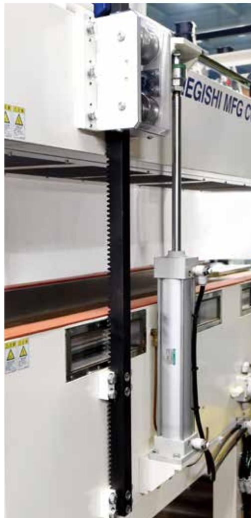
シリンダー式バッチカル構造ヒーター開放機構
